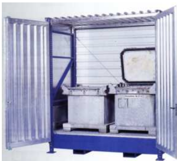
Abb. 2: Container Typ 3K2-O, außen lackiert, mit Flügeltüren, Auffangvolumen 1.000 Liter, zur Aufnahme von 2 Containern, der Dosierpumpe und des Steuerschranks, Maße ca. 2.880 x 1.500 x 3.390 mm
